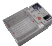
PCR実験が成功したか確認するために使用したサブマージ電気泳動装置
